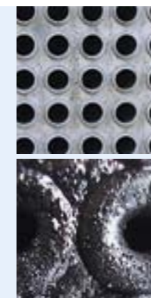
上图： 采用OASE技术的热交换器：全面防腐 下图： 不采用OASE技术的情况
